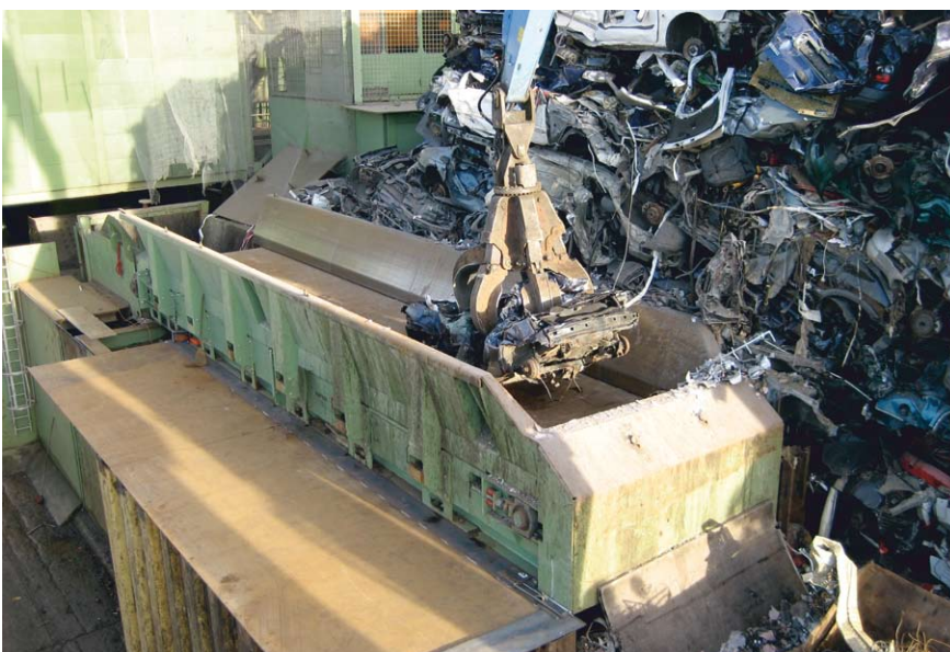
Beschickung des Plattenbandes bei der Thommen AG mit Autokarosserien und anderem Shredderschrott
