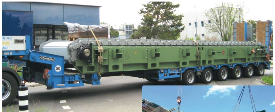
Das Plattenband mit einem Gesamtgewicht von circa 42 Tonnen verlässt das Werk der Wirtech AG mittels Schwertransport
