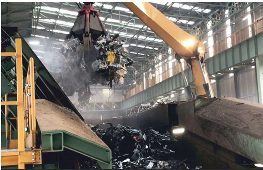
Aufgabe von Schrott in eine Sicon HMS Cleaning Anlage
