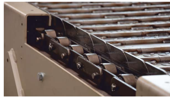
Der Fördergurt ist mit sehr breiten Laufrollen ausgerüstet, die eingeschraubten Schienen sind 12-mm-Stahl gefertigt
