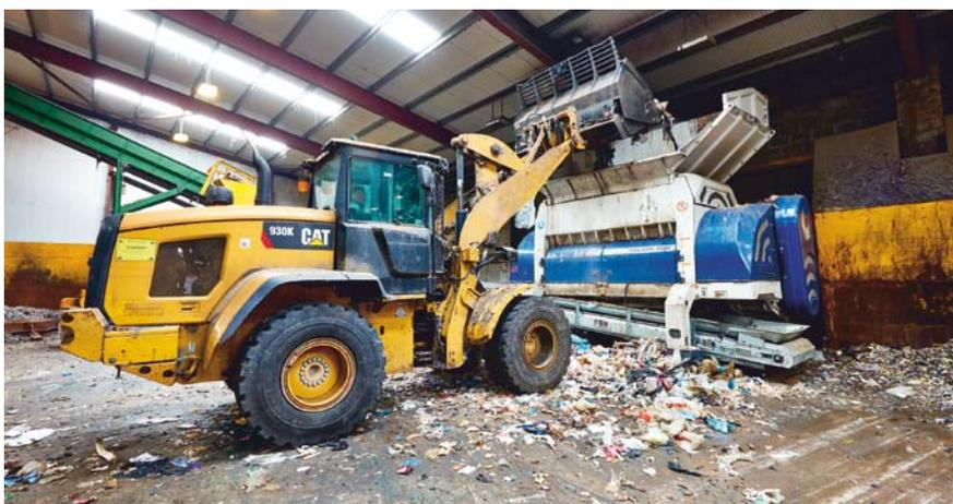
Einfache Beschickung des Shredders mit dem Radlader
