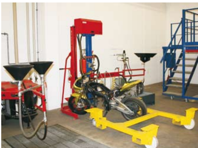
SEDA bietet auch Trockenlegungsanlagen für Motorräder. Ein besonderer Kunde ist BMW
