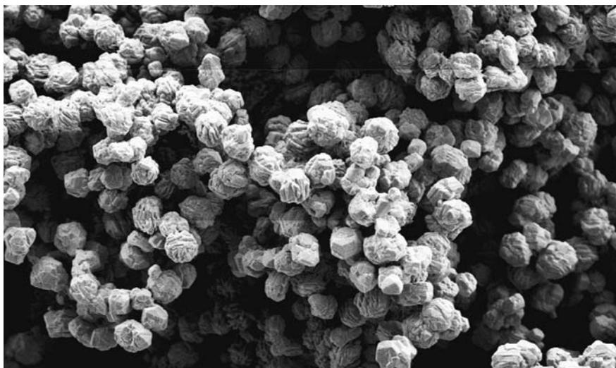
Rasterelektronenmikroskop-Aufnahme eines Silber-Pulvers aus der Elektroraffination
