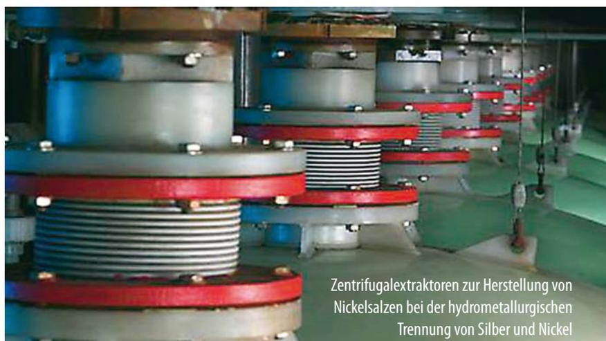
Zentrifugalextraktoren zur Herstellung von Nickelsalzen bei der hydrometallurgischen Trennung von Silber und Nickel
