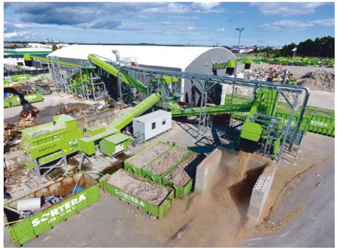
Haas Komplettanlage für das Recycling von Altholz, Industrieabfällen und Bauschutt
