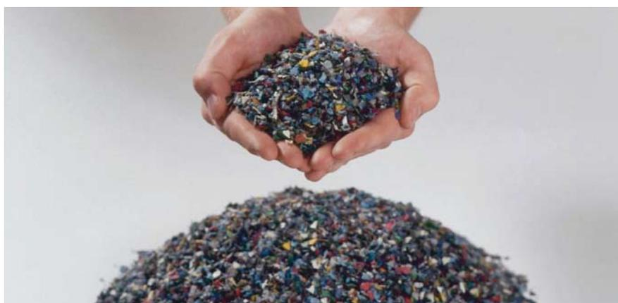
Die wiederverwertbaren Kunststoffmahlgüter (CryoPlast) gelangen zurück in den Stoffkreislauf – unter anderem zur Herstellung von Rohrleitungen oder Paletten
