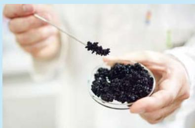
Mit diesen Granulaten wird Arsen aus Trinkwasser entfernt
