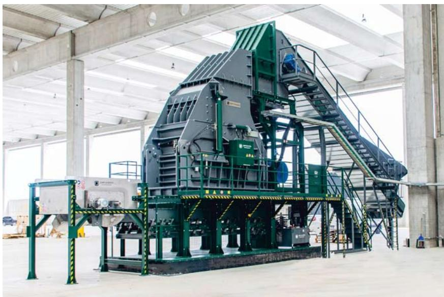
gen zu finden und die Produktivität unserer Hammermühlen deutlich zu verbessern. So erreicht zum Beispiel das neue Modell Panizzolo Mega 1500 – bei gleichem Energieverbrauch und gleicher Output-Qualität – eine Durchsatzleistung von 30 Tonnen pro Stunde.“
