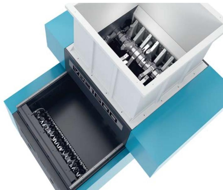
Mit dem innovativen Rotor im VPC 1600 wird das Holzmaterial vorgebrochen, bevor es die Schneidkronen des VHZ-Rotors zerkleinern
