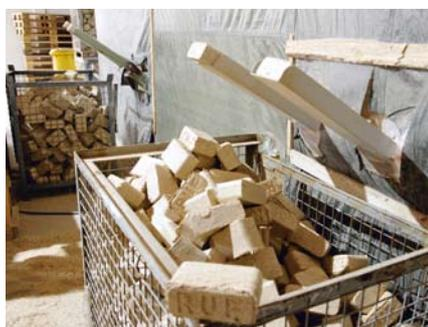
Über je zwei Auslaufschienen pro Presse werden die Briketts in Gitterboxen transportiert und anschließend verpackt
