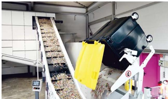
Das vorzerkleinerte und von Eisen befreite Material gelangt vom Container auf die Fördertechnik
