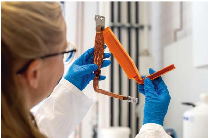
Verklebt oder verschraubt: Merle Zorn untersucht die Stromleitschiene einer Elektrofahrzeugbatterie aus Kupfer und einem Kunststoffgehäuse. Verschraubte Bauteile sind wesentlich recyclingfreundlicher
