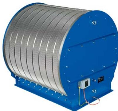
entlastungssysteme dienen dazu, die Auswirkungen einer Explosion innerhalb eines Prozessbehälters zu minimieren, indem sowohl der Explosionsdruck als auch die Flamme sicher nach außen abgeleitet werden. Ist der Flammenausstoß baulich jedoch nicht möglich, kommt eine flammenlose Druckentlastung zum Zuge: Bei diesem Ansatz wird die Flammenfront erstickt und der Druck der Staubexplosion zum Entweichen gebracht.
