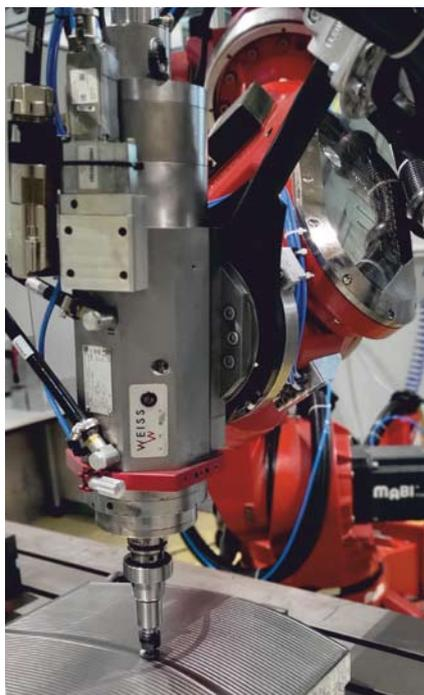
Hochpräzise Oberflächenbearbeitung mit Hilfe eines Roboters: Eine Ausgleichseinheit hält Anpresskraft und Abtrag beim Schleifen von Freiformflächen konstant
