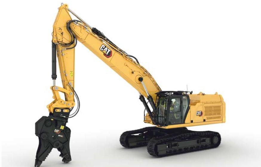
sich Schmutz ansammeln und so die Ketten beschädigen kann. Abgedichtete Laufwerksbolzen und Buchsen verringern Fahrgeräusche, wodurch die Nutzungsdauer des Laufwerks verlängert wird. Die Kettenführungs- und -schutzplatte über die gesamte Länge gehört auch zur Standardausrüstung.
