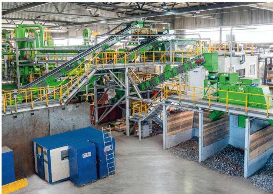
ansatz sehr zu schätzen“, merkt Patrick Wollenmann an. Nach den Erklärungen von Jan Dollenmaier, Co-Projektleiter bei Stadler, sortiert der STT5000 Ballistikseparator das Material in drei verschiedene Fraktionen: Feinstoffe, flache Kunststoffe und Kabel sowie kubisches Material wie Elektromotoren.
