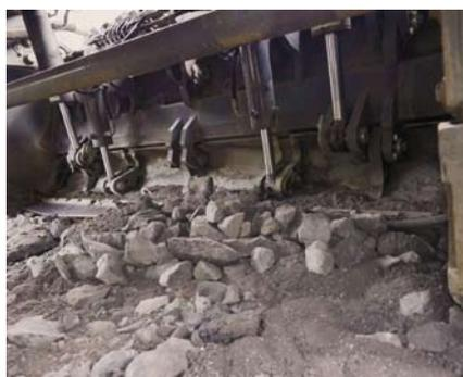
Packlagen und Steine mit einer Kantenlänge bis zu 300 mm können gebrochen werden
