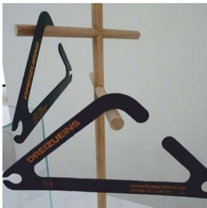
Münster ist für „Dreizeins“ verantwortlich, einen Kleiderbügel, der im wesentlichen aus drei Teilen Staub (aus Wäschetrocknern) und einem Teil aus Speisestärke besteht, formgepresst wird und eine (wasserlösliche) Klarlack-Versiegelung erhält.
