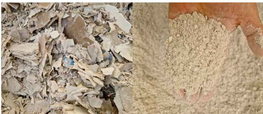
Aus ausgedienten Gipskartonplatten entsteht hochwertiger RC-Gips
