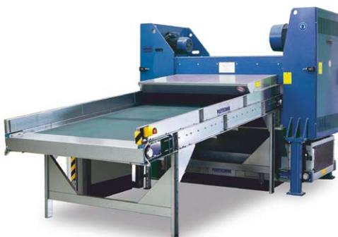
Bogenwaren schnell und einfach manuell zerkleinern mit dem PHSS Shredder
