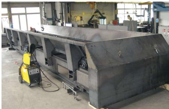
Produktion Plattenband PB150/15 im Wirtech-Werk
