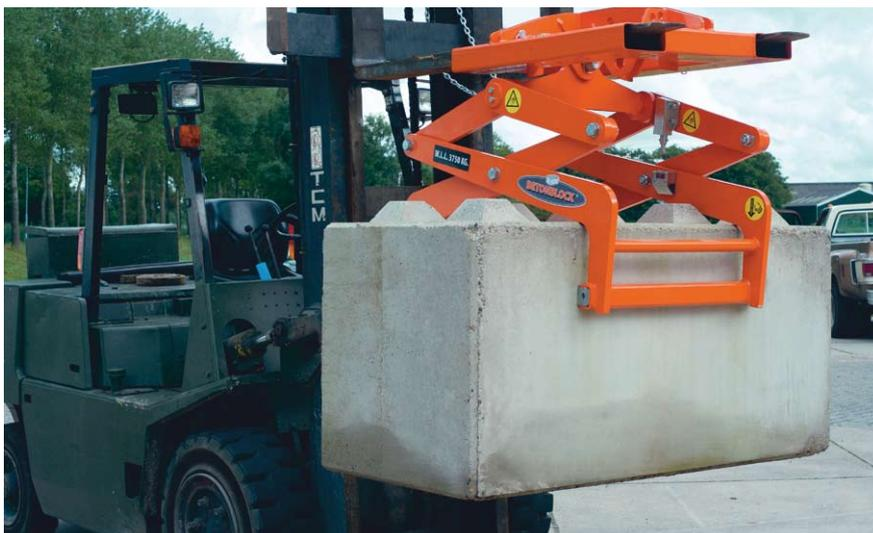
ein immer wieder erneut versetzbares Stapelsystem erzeugen, das ohne den Einsatz von Zement stabil ist. Ähnlich wie das Lego-System lassen sich die Blöcke – durch Noppen auf der Oberseite und Vertiefungen auf der Unterseite der Blöcke – ineinander stecken. Durch die Stabilität des Stapelsystems sind die Konstruktionsmöglichkeiten grenzenlos erweiterbar – ideal für temporäre oder permanente Gebäudestrukturen. Die Stabilität des Systems bietet zudem mehr Sicherheit auf Baustellen.
