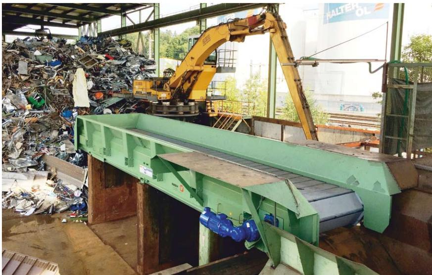
Plattenband bereit für die Beschickung des Shredders
