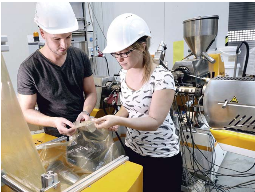
Aus rezykliertem Verpackungsabfall entsteht im Fraunhofer IVV eine reine PE-Folie mit Neuware-Eigenschaften
