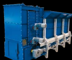
Aufgabe- und Dosierbunker
