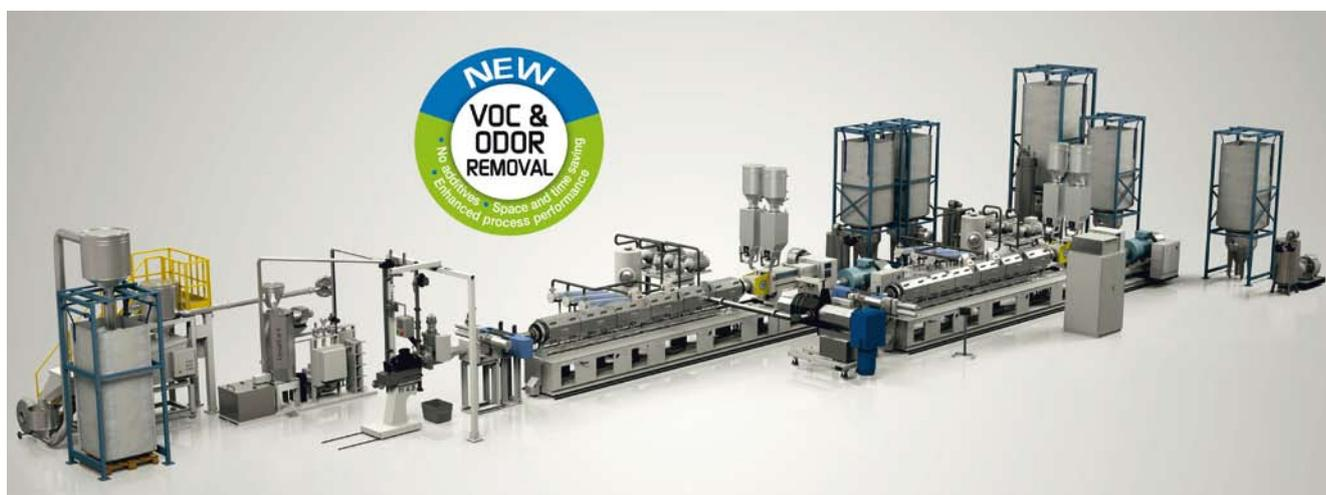
dera entwickelte Doppelschnecken-technologie – sowohl im Kaskaden- als auch im Einzelsystem – ist für die Verarbeitung von Post-Consumer- und postindustriellen Polyolefinen (HDPE, PP, LDPE, auch mit Barrierschichten) sowie von Styrolharzen und Polycarbonat vorgesehen. Die 360-Grad-
