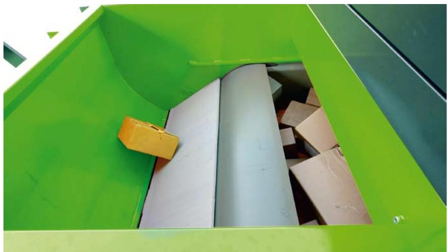
Durch den Überwurfkolben mit Selbstreinigungseffekt – eine Entwicklung aus dem Hause Bergmann – bleiben die Abfall-Press-Boxen zu jeder Zeit befüllbar und sauber
