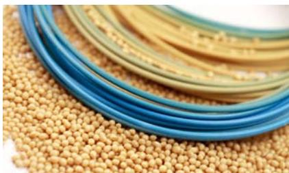
Flammgeschützter Biokunststoff könnte zu Bauteilen für Elektrotechnik und Elektronik verarbeitet werden, beispielsweise mittels Spritzguss (Bio-Granulat) und additiver Fertigung (Bio-Filamente)
