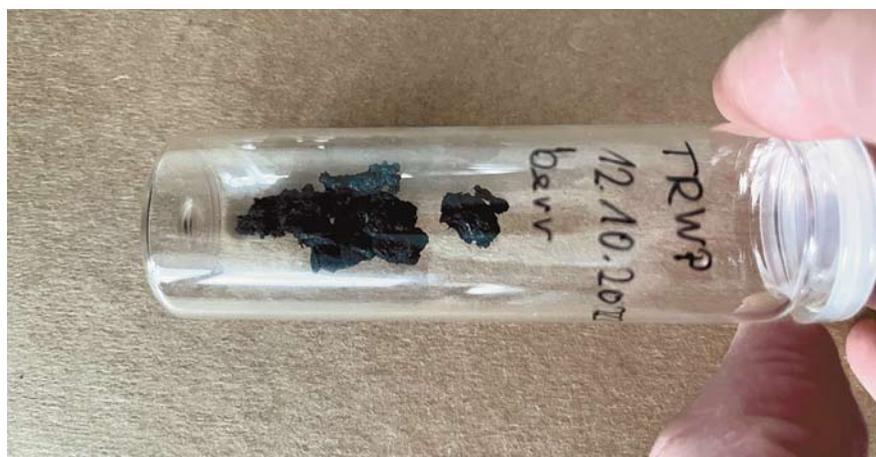
Sogenannte TRWP (Tyre and Road Wear Particles): Durch Niederschläge, Wind oder fahrzeuginduzierte Aufwirbelung können sie von der Straße weiter in Luft, Wasser und Boden gelangen
