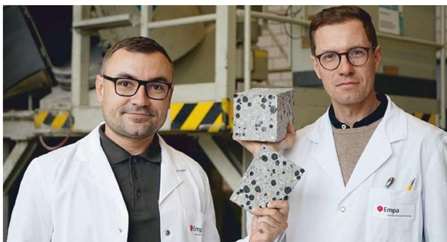
Beton ohne Emissionen: Empa-Forscher Nikolajs Toropovs (links) und Mateusz Wyrzykowski ersetzen herkömmliche Gesteinskörnungen durch Pellets aus Pflanzenkohle und loten damit das Potenzial von CO<sub>2</sub>-neutralem oder gar CO<sub>2</sub>-negativem Beton aus
