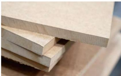
Faserplatten aus Recyclingfasern, die dank der Osiris-Technologie produziert werden konnten
