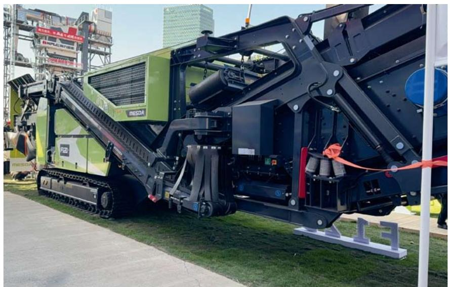
Der F12 überzeugt mit hohem Reduktionsvermögen und innovativen Features wie dem aktiven Doppeldecker-Vorsieb
