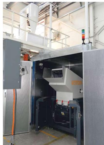
Für den Einsatz in der Recyclinganlage von Hansgrohe stattete Getecha seine Trichtermühle RS 30060 mit einem Mahlgehäuse mit integrierter Schalldämmverkleidung und einer Lärmschutzkabine aus
