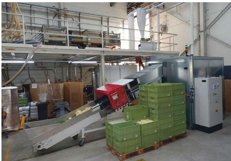
Getecha lieferte die gesamte Prozessstufe der Vorzerkleinerung der neuen Recyclinganlage von Hansgrohe, bestehend aus Schneidmühle, Förderbandtechnik sowie Entstaubungs- und Abluftsystem
