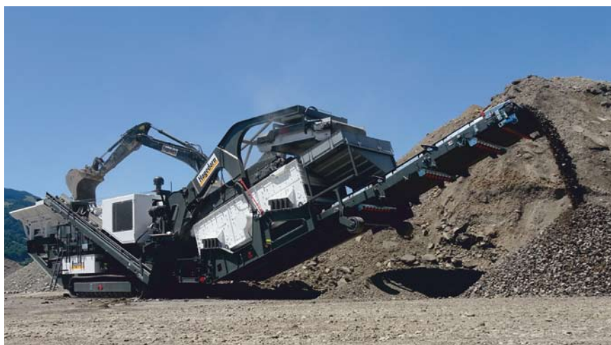
Bei der Giporec R 130 FDR GIGA DA handelt es sich um eine mit einer Prallmühle vom Typ P 130 ausgestattete raupenmobile Anlage, die jederzeit sehr schnell um eine 1- bis 3-Deck-Siebeinheit erweitert werden kann
