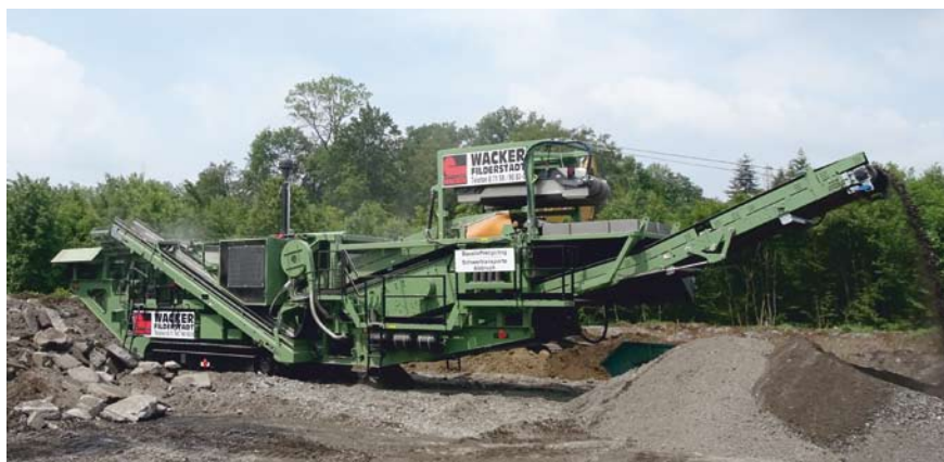
Auf der raupenmobilen Gipokombi RC 130 FDR DA sind der leistungsstarke Prallbrecher vom Typ P 130 und die große 2-Deck-Siebmaschine auf einem gemeinsamen Maschinen-Grundrahmen montiert
