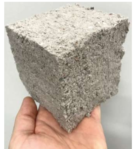
Eine Einblasdämmung wird zum soliden Dämmstoff
