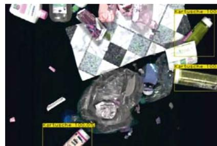
Der Intelligent Object Identifier erkennt Silikonkartuschen und ermöglicht dadurch silikonrestfreie PE-Produkte
