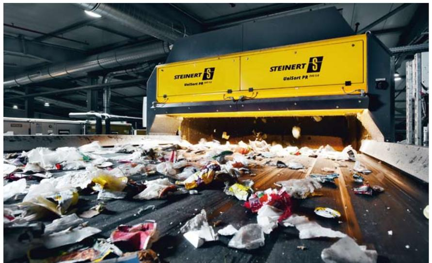
Die UniSort PR EVO 5.0 – die fünfte Evolutionsstufe der NIR-Sortiermaschine mit HSI-Kameratechnik
