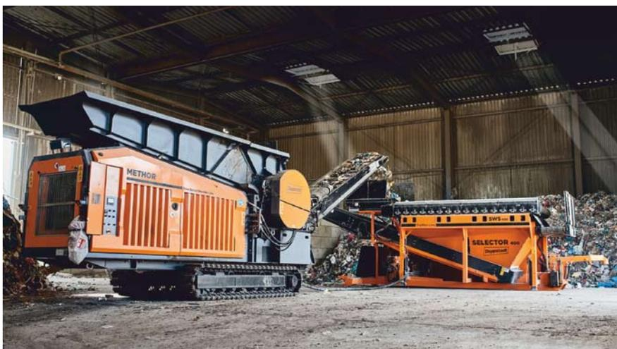
Die mobil-modulare Kombination aus Methor und Selector 400 vereint Vorzerkleinerung und Materialtrennung in einem Arbeitsgang
