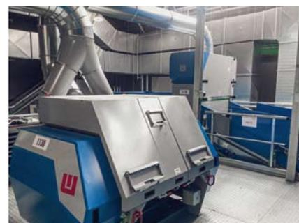
Das AirWheel ist eine dem AirLift nachgeschaltete Einheit. Hier wird die leichte Fraktion mittels rotierender Siebtrommel dem Luftstrom entnommen. Das verbleibende Staub-Luft-Gemisch wird einem Staubfilter zugeführt
