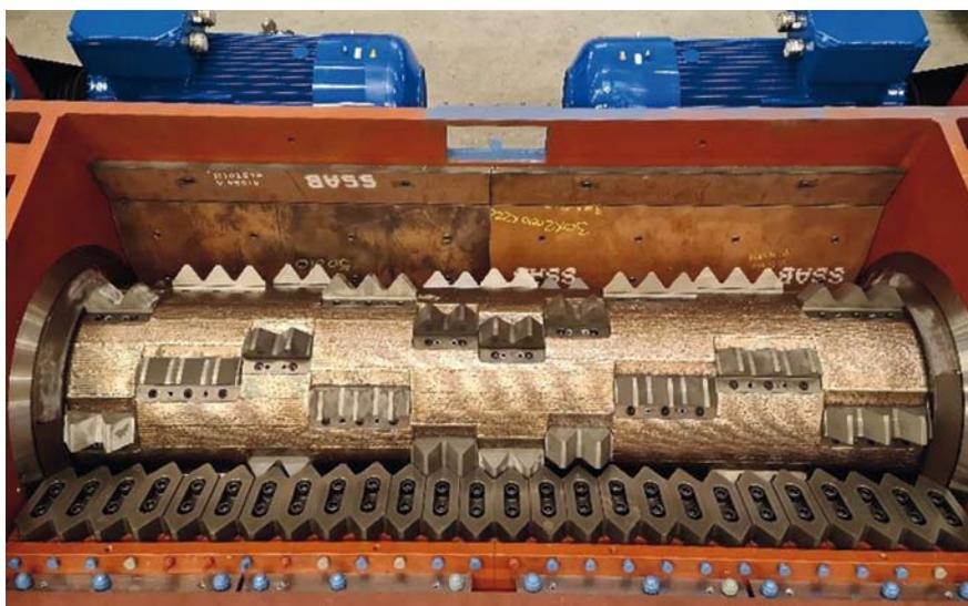
Bild des neuen Rotordesigns mit dem 2 + 3-Messersystem, montiert in einer unfertigen Maschine
