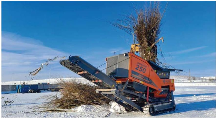
erleichtert die Wartung und Reinigung der Einheit. Die Abwurfhöhe des Austragsbandes beträgt drei Meter, was laut Ihainen sehr gut für ein Gerät dieser Größe ist. Der Bediener des Beschickers kann mit der Fernbedienung die Funktionen des Geräts steuern und bei Bedarf das Gerät unter anderem versetzen. Alle Steuerfunktionen sind
