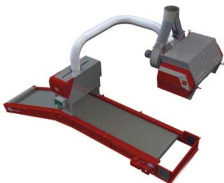
Der AirLift verwendet das diametrale Fallstromprinzip in der Beruhigungskammer, um die unterschiedlichen Fraktionen in einer zweiten Stufe noch genauer zu trennen. Dabei lassen sich die Betriebsparameter über die integrierte Solldruck-Steuerung exakt einstellen
