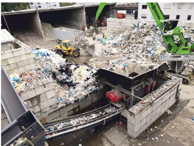
Das Input-Material hat eine Schüttdichte von etwa 200 bis 250, der Produktionsabfall 120 bis 180 Kilogramm pro Kubikmeter. Mitarbeiter sortieren das Material mit Greiferbaggern und Radladern grob vor und geben es in die Vorzerkleinerung
