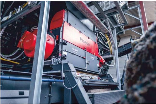
Für die Nachzerkleinerung hat Vecoplan den VEZ 2500 TT installiert. Der Schredder ist mit einem Hochleistungsschneidwerk auf maximalen Durchsatz ausgelegt
