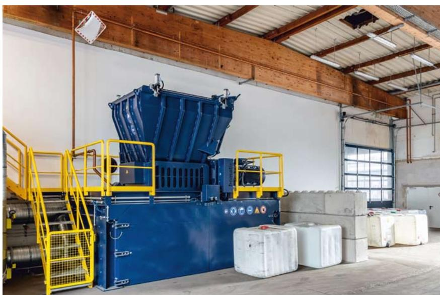
Diese Rotorschere gehört zur schweren Baureihe aus dem bomatic-Portfolio. Sie schneidet mit 70 kW Antriebsleistung die IBC kraftvoll und zuverlässig und ist dabei geräusch- und staubarm
