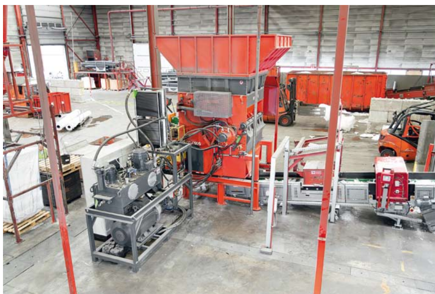
WEIMA W5.18 Einwellen-Zerkleinerer bei RKW
