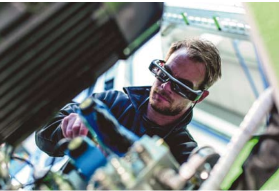
Setzt ein Mitarbeiter die Datenbrille vor Ort auf, kann ihm ein Service-Techniker alle relevanten Informationen ins Sichtfeld einblenden
