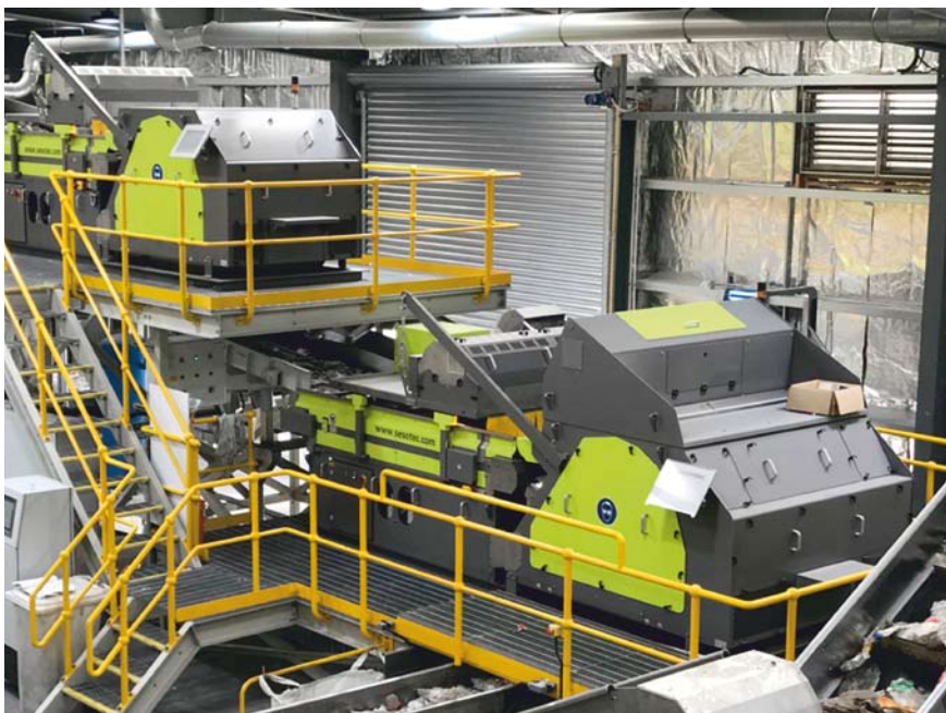
Flight Plastics installierte eine Multi-Sensor-Sortierlinie mit zwei Sesotec Flaschen-Sortiersystemen
