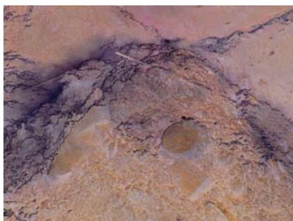
Typisches Ausgangsmaterial bei der Aufbereitung von Müllverbrennungsasche. Bis zu 20 Prozent metallische Bestandteile können hier enthalten ein
