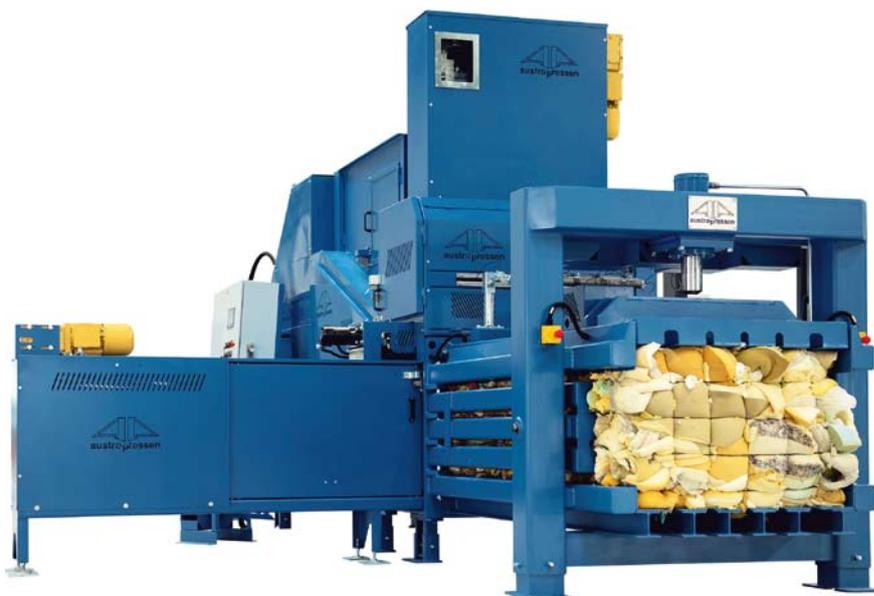
Die bei Retour Matras eingesetzten Austropressen sind für Schaumstoff und expandierendes Material konzipiert
