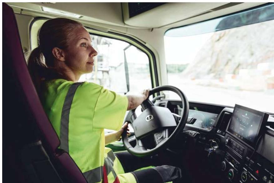
volumen wurde um einen Kubikmeter erhöht, was für mehr Komfort und einen größeren Arbeitsraum sorgt. Die Sicht ist jetzt noch besser dank größerer Fenster, einer abgesenkten Türlinie und neuer Spiegel.
