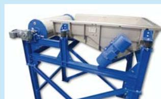
Schwingförderrinne mit Magnetabscheidetrommel
