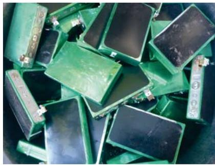
Lithium-Ionen-Batterien/-Akkupacks aus dem Automotive-Bereich
