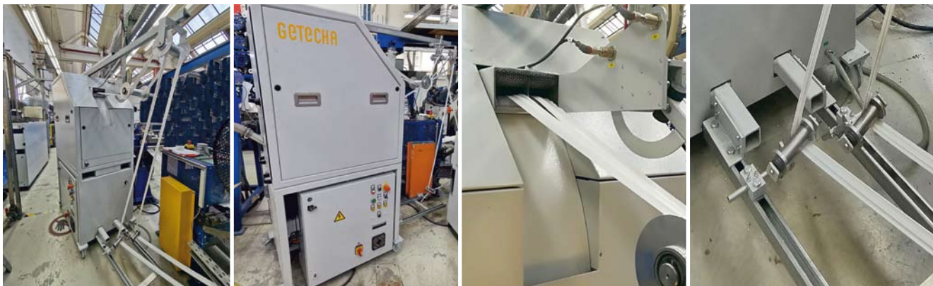
Bild 1: An einer Extrusionsanlage zur Herstellung von Antriebsriemen und Fördergurten zieht die Schneidmühle RS 2404 E von Getecha gleichzeitig zwei Randstreifen aus TPE oder TPU 50-95 Shore A ein und zerkleinert sie zu hochwertigem Mahlgut; Bild 2: Auf Wunsch des Kunden erhielt die RS 2404 E ein schallgedämmtes Maschinengestell mit integriertem Schaltschrank und Lenkrollen. Die mobile Einheit fällt sehr schlank aus und lässt sich platzsparend direkt neben der Konfektionierungs- oder Extrusionslinie positionieren; Bild 3: Der zweigeteilte Trichter der RS 2404 E ermöglicht das gleichzeitige Einlaufen von zwei Randstreifen in den Rolleneinzug, ohne dass diese über Kreuz laufen und sich verwirren können; Bild 4: Um eine Zuführung der zu zerkleinernden Randstreifen schon ab Bodenhöhe zu ermöglichen, stattete Getecha die Schneidmühle RS 2404 E mit zusätzlichen Auslegern und Umlenkrollen aus
