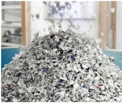
Akten werden bei Regens Wagner Dillingen mit dem Zerkleinerer RS40 entsprechend der Sicherheitsstufe P3 auf eine Partikelgröße von 320 mm<sup>2</sup> zerkleinert
