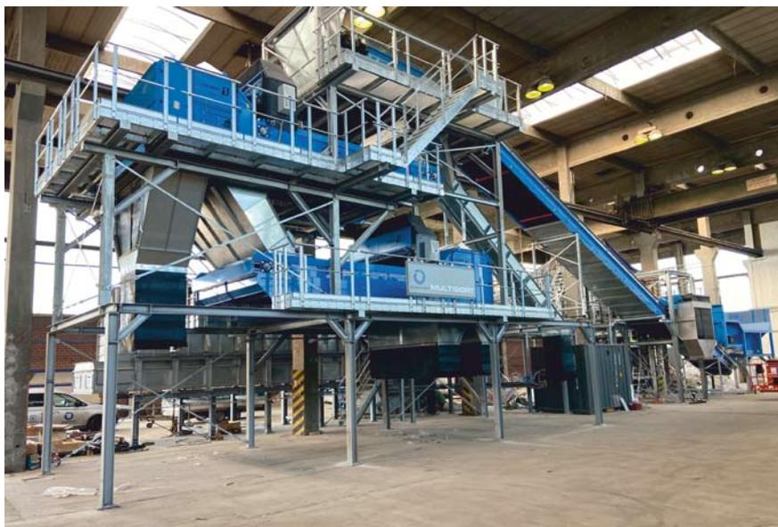
Die Separation mit der SPLITTER-Technologie liefert dabei eine nahezu sortenreine Stein- und Brennfraction und sorgt durch die robuste Bauweise für eine hohe Prozesssicherheit.
