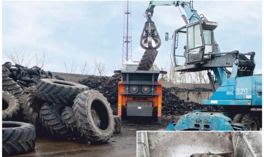
Durch die Kraft der asynchron laufenden Paddelwellen werden selbst schwerwiegendste Altreifen zerkleinert
