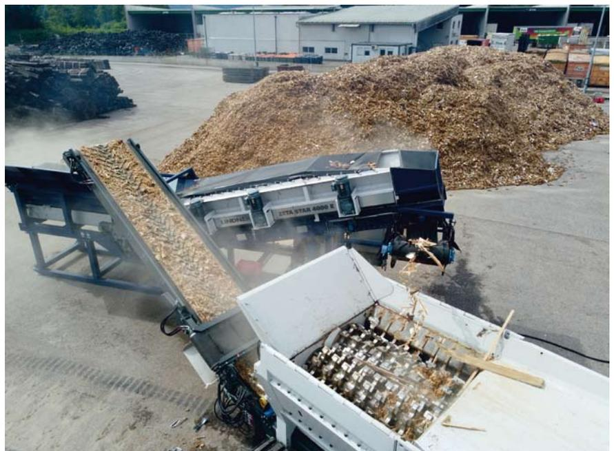
Das patentierte Lindner Schnittsystem produziert bereits im ersten Produktionsschritt ein gleichmäßiges Endkorn der Klasse P100. Wird eine Klassifizierung P63 F5 nach EN ISO17225-1 benötigt, so kommt die Systemlösung, bestehend aus einem Urraco 4000-Zerkleinerer und dem Zeta Star 4000-Sternsieb, zum Einsatz
