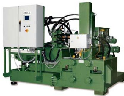
Diese im sogenannten Stopfmodus arbeitende Schnecke bringt bereits eine deutliche Volumenreduzierung. Sie ist durch eine spezielle „Aufpanzerung“ verschleißgeschützt und wird über einen gesteuerten Getriebemotor betrieben.
