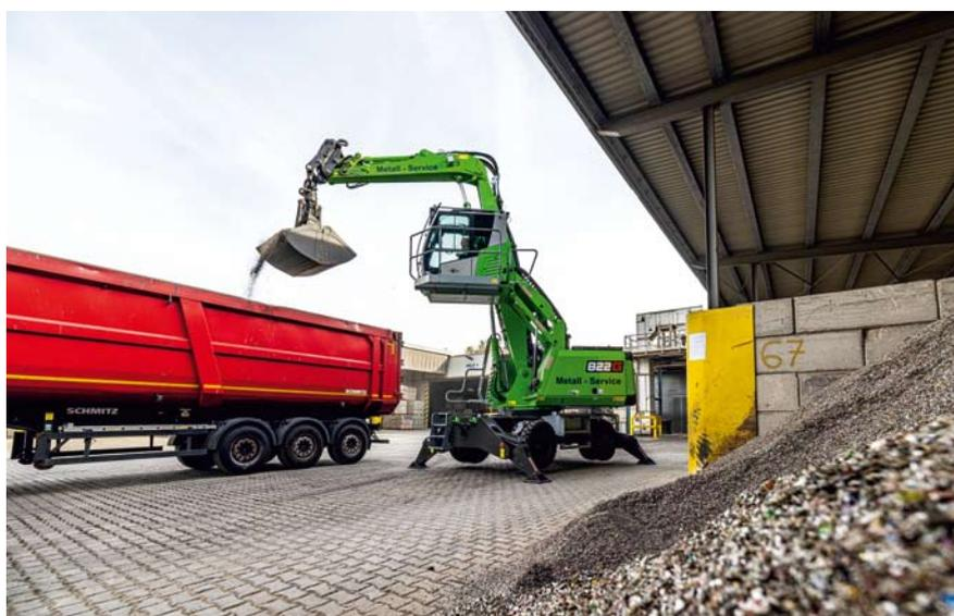
822 G Mobil – Die hochfahrbare Kabine ermöglicht eine optimale Sicht
