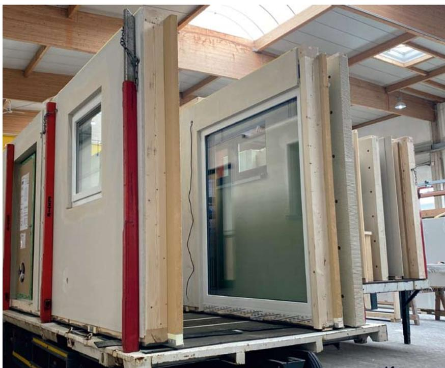
Konventionelle Holztafelwände eines Fertigteilhauses bei der Verladung
