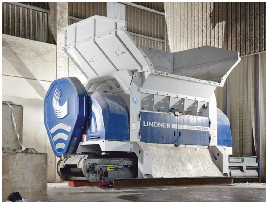
Die Jupiter 3200 ist mit einem vierfach verwendbaren und besonders stoffunempfindlichen Spitzmesser-Schnittsystem ausgestattet und sorgt dank des zweistufigen Riemenantriebs mit Vorgelege und Schwungmassespeicher für konstant hohen Durchsatz auch bei zähen Materialien
