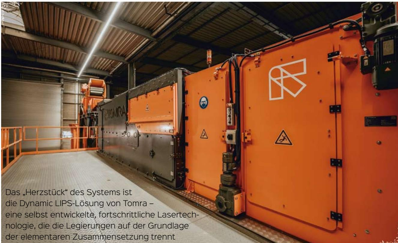
Das „Herzstück“ des Systems ist die Dynamic LIPS-Lösung von Tomra – eine selbst entwickelte, fortschrittliche Lasertechnologie, die die Legierungen auf der Grundlage der elementaren Zusammensetzung trennt
