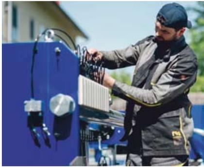
Die Kammerfilterpresse wird als vormontierte Einheit im Container geliefert. Für Kunden bedeutet das eine erhebliche Zeitersparnis beim Aufbau und eine vereinfachte Inbetriebnahme.
