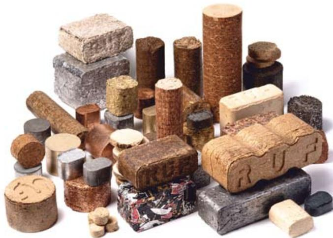
Brikettieren ist möglich bei Aluminium, Stahl, Kupfer, Gold, Schleifschlamm, Kunststoffstäuben, Holz, Papier, Textilstäuben und vielen organischen Materialien
