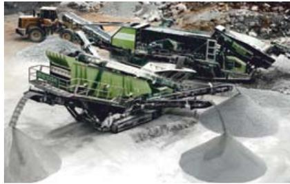
oder spezieller Körnungen mit besonderer Qualität bei gleichzeitig hoher Leistung sicher.“ Mit der S12 erhalten Anwender, die bisher auf stationäre Lösungen setzten, nun eine mobile Lösung mit geforderter Qualität und Durchsatzleistung. Mit drei Metern Breite und einem Gesamtgewicht von etwa 42 Tonnen eignet sich die Siebmaschine für den Straßentransport. Wie alle Mesda-Anlagen für den europäischen Markt ist auch die S12
