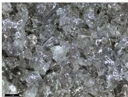
Wassergranulierte Elektro-roheisenschlacke im Auflichtmikroskop
