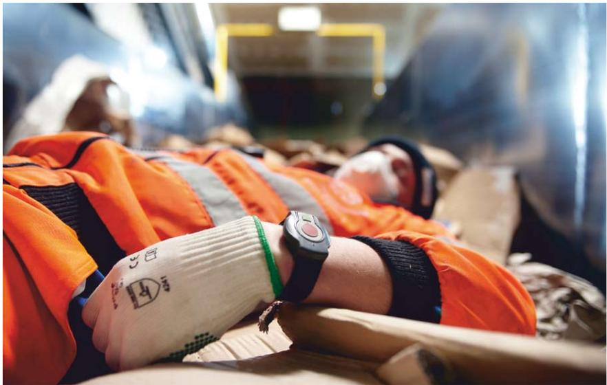
ben vor, dass an den Förderbändern Geländer oder sonstige Schutzeinrichtungen in einer Mindesthöhe von 1,10 Metern angebracht werden müssen. Ist dies nicht möglich, weil sonst der Arbeitsablauf gestört wird, ist eine „sensitive Schutzeinrichtung“ zu wählen. In beiden Fällen bietet das U-Tech-Personenschutzsystem Betrieben die Möglichkeit, den Sicherheitsanforderungen der Berufsgenossenschaften gerecht zu werden.
