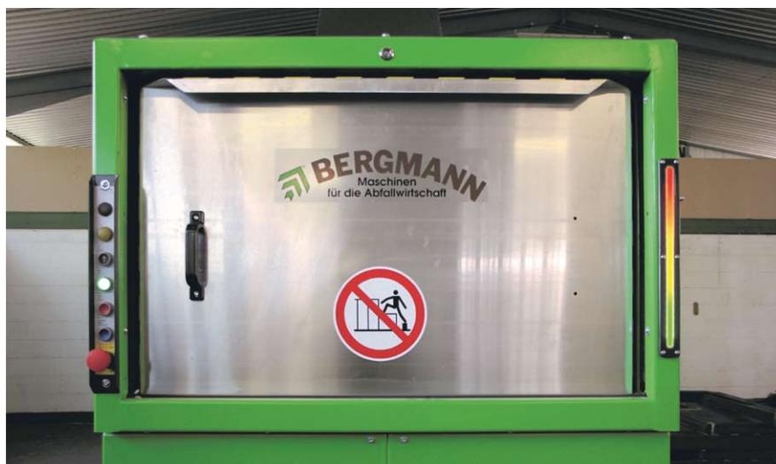
Die neue 7fach-Tastatur (links) korrespondiert mit der optischen Füllstandanzeige (rechts), die von grün über gelb bis rot ein Signal zum Wechseln der Sackeinheit gibt
