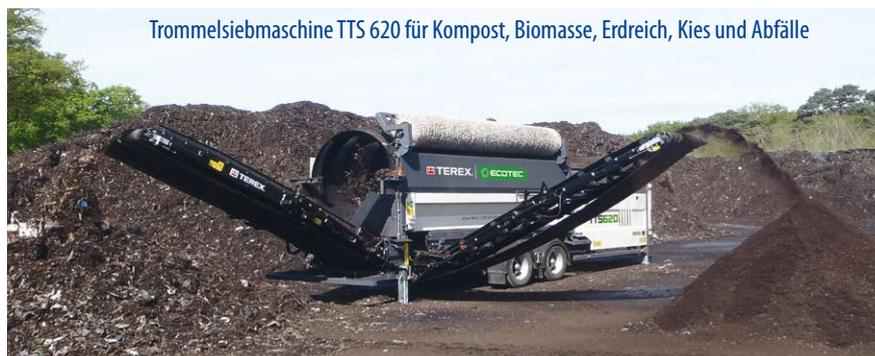
Trommelsiebmaschine TTS 620 für Kompost, Biomasse, Erdreich, Kies und Abfälle
