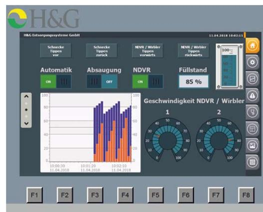
Benutzeroberfläche der Steuereinheit zur Fernbedienung und Wartung von Schneckenverdichtern
