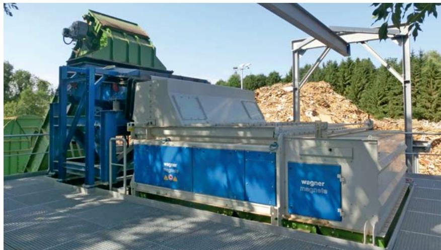
Die angegebenen Vorteile zusammengefasst: robustes Design, hohe Betriebssicherheit, wartungsarme Ausführung, exzentrisches/einstellbares Polrad, sehr große Tiefenwirkung, größtmögliches Magnetvolumen,
