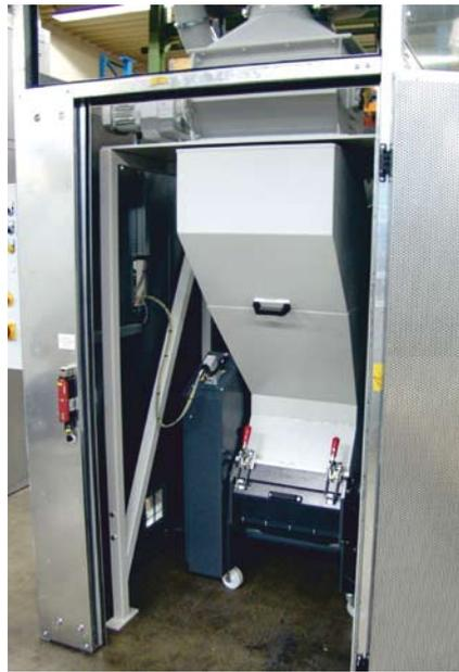
Technisches „Herzstück“ der Kaffeekapsel-Zerkleinerungslinien von Getecha: die Schneidmühlen der RotoSchneider-Baureihe RS 2400
