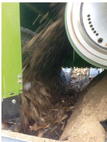
Millimetern ermöglicht die Nachschaltung direkt hinter einen Shredder, ohne sonstige Fördertechnik installieren zu müssen. Die große Aufgabehöhe von circa 4.000 Millimetern erspart ein weiteres Haldenband und bietet
