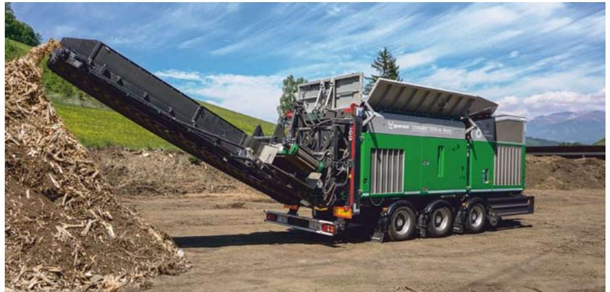
Mit dem Crambo lassen sich von sperrigem Ast- und Strauchschnitt über Wurzelstöcke jeglicher Größe bis hin zu Altholz alle möglichen Stoffgruppen wirkungsvoll zerkleinern
