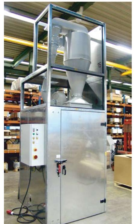
Selbst bei schwankenden Volumina oder Produktionsspitzen gewährleistet die Kaffeekapsel-Zerkleinerungslinie eine ebenso gleichmäßige wie vollständige Erfassung der Fehlteile unmittelbar an der Thermoforming-Anlage
