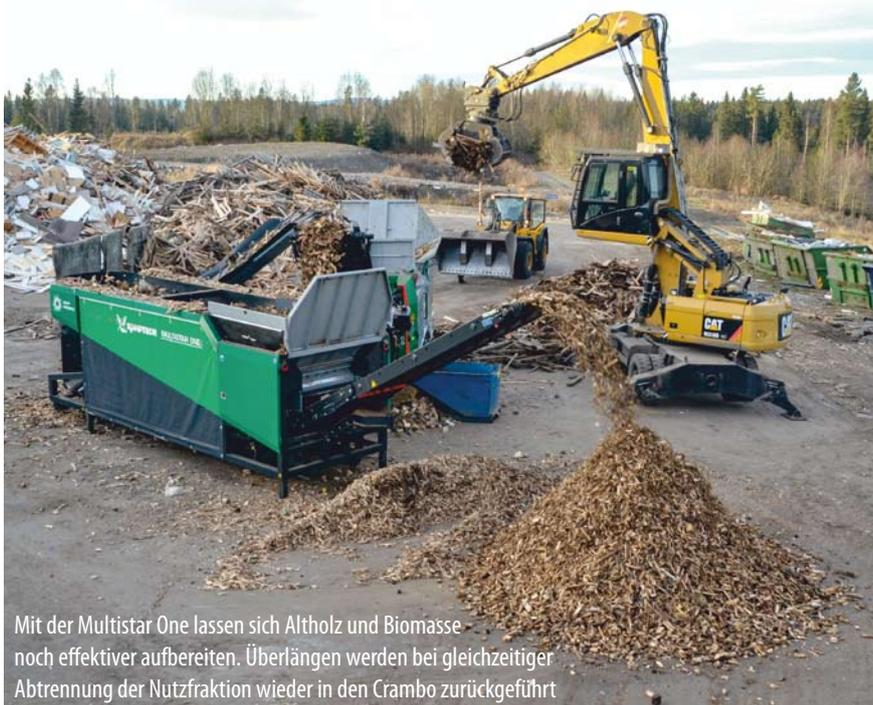
Mit der Multistar One lassen sich Altholz und Biomasse noch effektiver aufbereiten. Überlängen werden bei gleichzeitiger Abtrennung der Nutzfraktion wieder in den Crambo zurückgeführt
