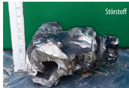
Störstoffe im Eingangsmaterial werden automatisch abgeschieden. Die Maschine muss zum Entfernen der Fremdkörper nicht extra gestoppt werden; Stillstandzeiten werden somit deutlich minimiert und Kosten reduziert. Im stationären Bereich ist die HAAS Hammermühle Arthos bislang als „HSZ“ bekannt und bereits seit Jahren ein beliebter Nachzerkleinerer unter Kennern.
