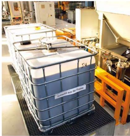
Das ausgepresste Schleiföl wird direkt an der Brikettieranlage gefiltert und in IBC-Containern gesammelt
