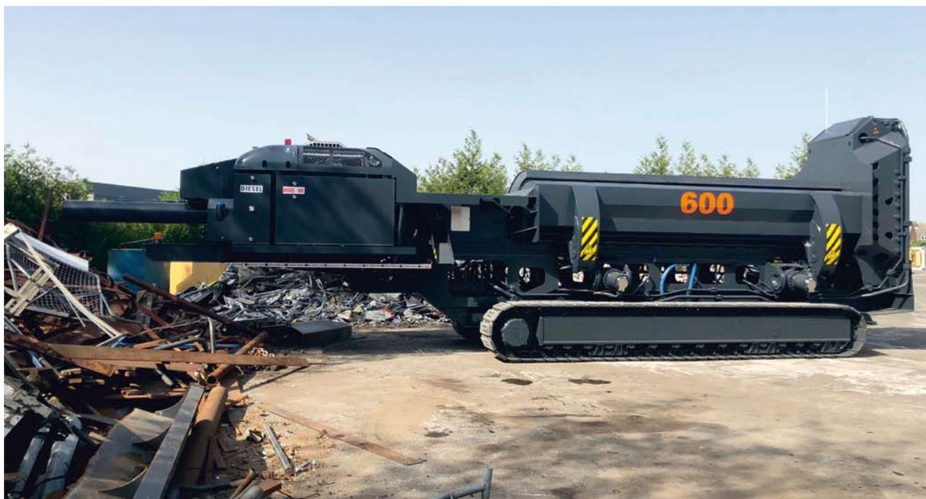
Autoverwertung ist nach dem Schrotthandel das zweite Standbein der Firma Nasz. Pro Stunde 25 und im Monat bis zu 850 Fahrzeugkarosserien werden mit der Trax 600 verdichtet
