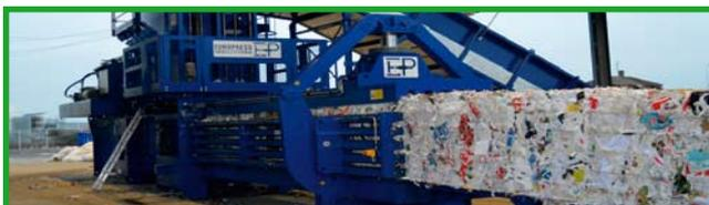
Kanalballenpressen mit Draht- und Garnabbindung
