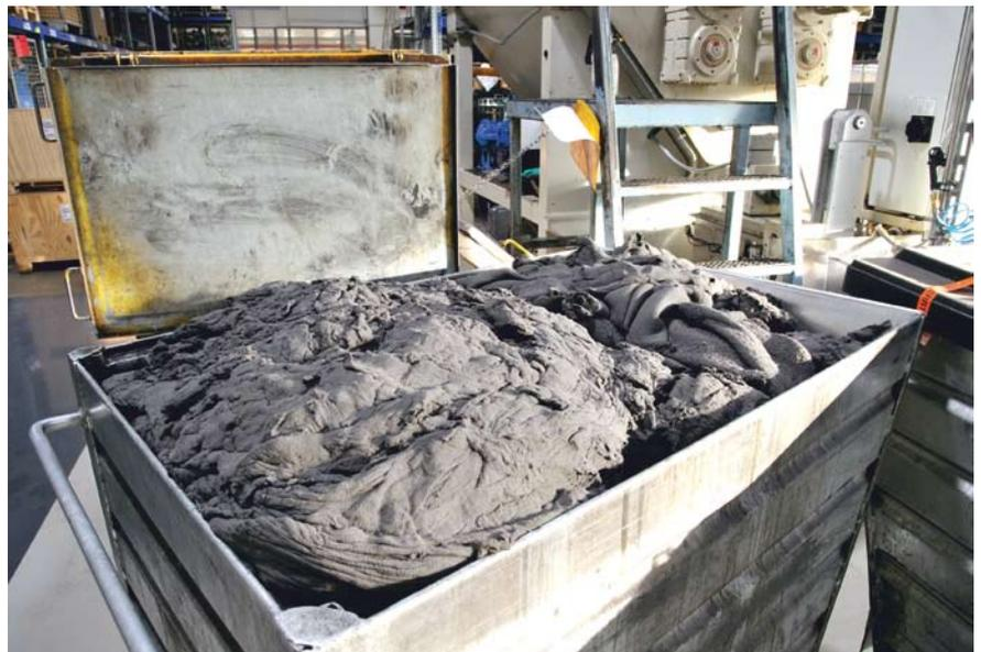
Der Schleifschlamm aus der Stahlbearbeitung wird in 0,4 Kubikmeter fassenden Behältern (hier im Werk Thyrnau) zur Brikettierpresse transportiert und per Gabelstapler in den Vorratstrichter der Anlage gefüllt
