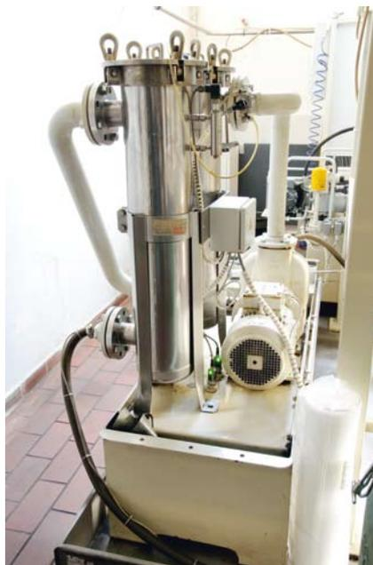
Um das Öl nach dem Herauspressen aus dem Schleifschlamm von Feststoffen zu befreien, durchläuft es noch an der Brikettieranlage ein zweistufiges Filtersystem, das Ruf zusammen mit der Anlage installiert hat
