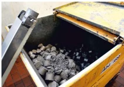
Über eine Auslaufschiene schiebt die Ruf-Anlage den zu Briketts komprimierten und weitgehend ölfreien Schleifschlamm direkt in Sammelbehälter
