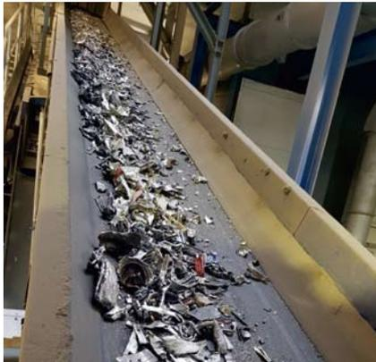
Die Profile verlassen den Rotorshredder: nicht nur zerkleinert, sondern auch aufgeschlossen
