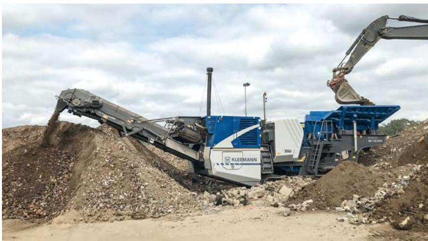
Die Mobicat MC 110(i) EVO2 ist für die erste Brechstufe konzipiert und wird in mittelhartem bis hartem Naturstein und im Recycling eingesetzt
