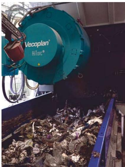
Eine wichtige Stellschraube bei der Zerkleinerung von Abfällen: der Antrieb für den Rotor
