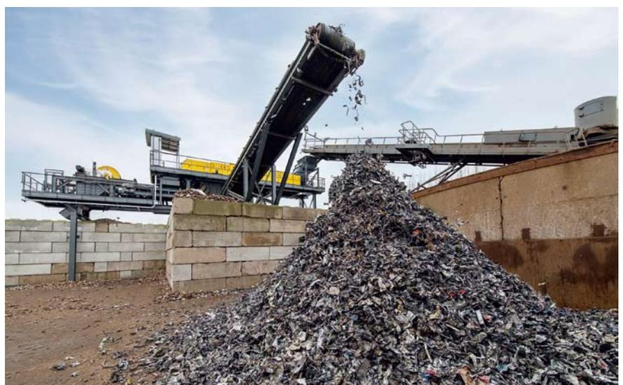
Steinert SteelMaster produziert sauberen Stahl. 80-90 % des Volumens sind nach der Sortierung ofenfertig
