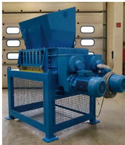
Der neue Vierwellenzerkleinerer B4WV-L, der auf der IFAT gezeigt wird, erreicht einen Durchsatz von bis zu 500 Kilogramm an Festplatten, Elektronikschrott und Blechgebinden pro Stunde
