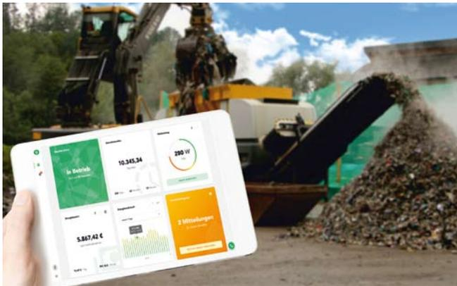
Mit dem Assistenzsystem „Untha Genius“ kann der Betrieb des Schredders laufend überwacht werden
