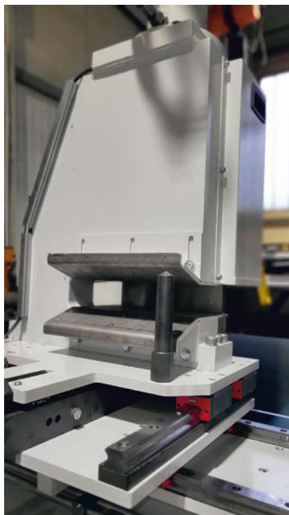
Hydraulik-Guillotine GH 300 HYD: Das Bild zeigt den neuen Vorschneider, montiert auf einer Linearführung mit Verstelleinheit
