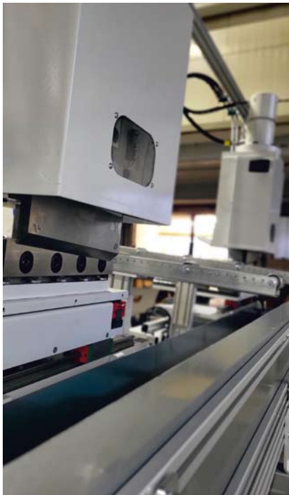
Die GH 300 HYD hinter einer Extrusionslinie mit quer ausstragendem Förderband
