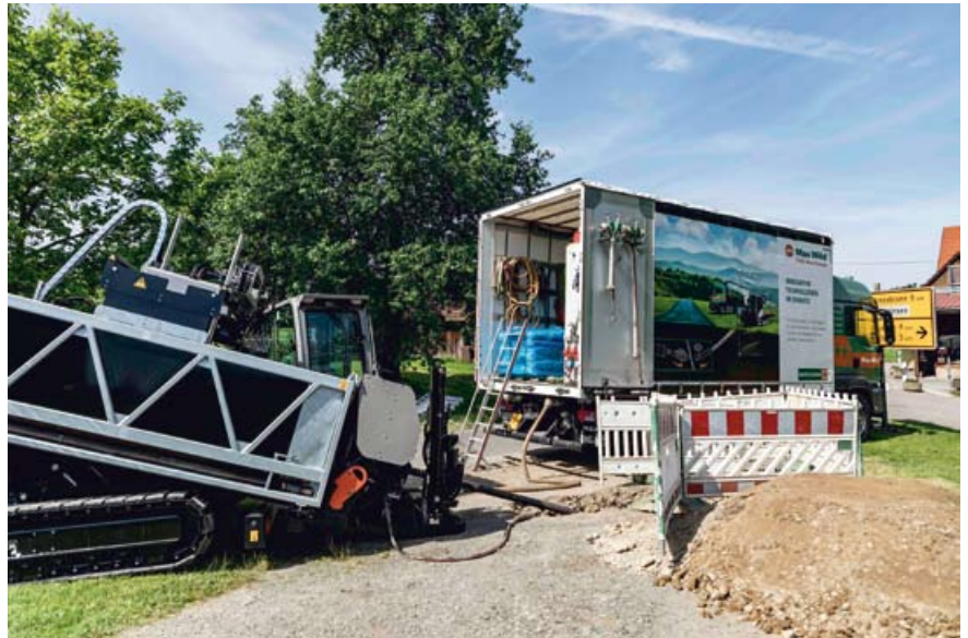
Der Mudcleaner Truck ist als Gesamtzugkonzept von Lkw und Bohranlage konzipiert
