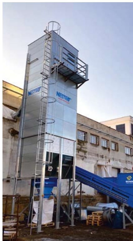
Typischer NESTRO® JET-Unterdruckfilter im Einsatz in der Recyclingindustrie
