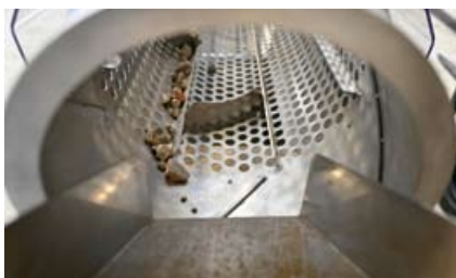
Blick in eine Separiertrommel zum Vorsieben neuer Proben
