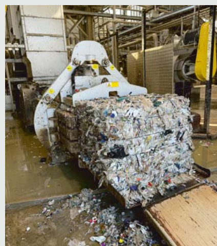
Endprodukt Rejektballen: Restfaseranteil < 5 %; Trockengehalt > 60 %
