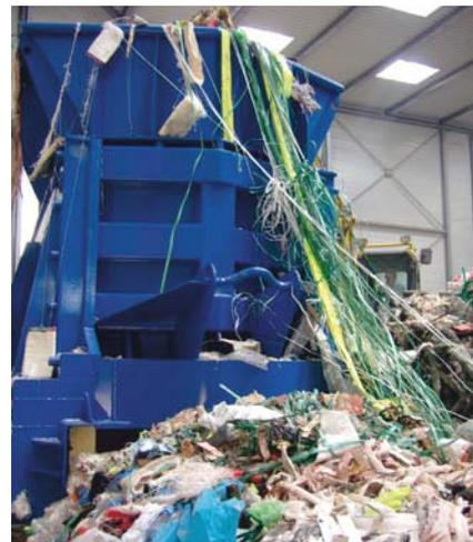
Störstoffe im Aufgabebunker und zerkleinert am unteren Austrag der Containerschere
