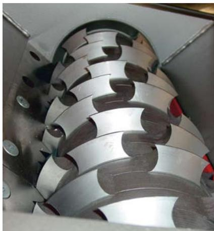
Der Einwellen-Zerkleinerer M600/1 ist besonders für einen exakten Materialaufschluss in einem Arbeitsschritt geeignet
