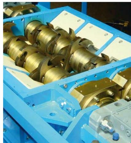
Die Schneidwerksgröße des RM1350/2 variiert in der Länge je nach Anwendung von 1.500 bis 2.500 mm. Die Breite beträgt 1.350 mm, kann aber auch kundenspezifisch angepasst werden
