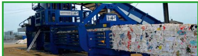
Kanalballenpressen mit Draht- und Garnabbindung
