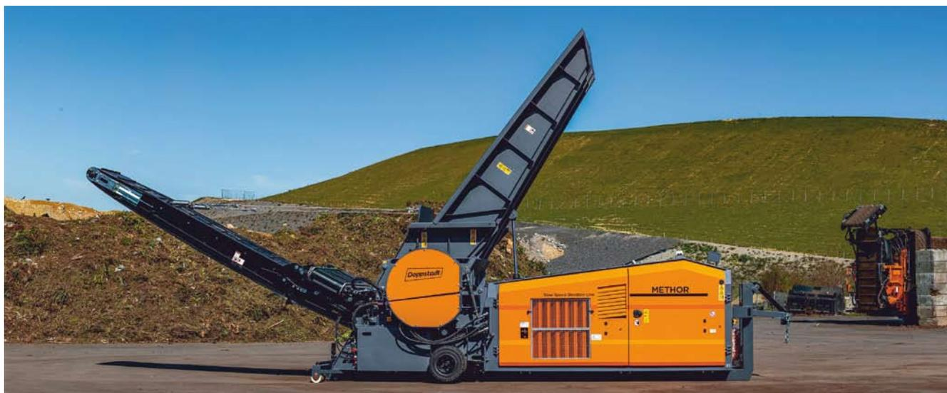
Der hydraulische Antrieb „HydraulicDirect Drive“ passt die Leistung des Zerkleinerungssystems stufenlos an den Bedarf an. Eng verknüpft mit dem Antrieb arbeitet die lastgesteuerte Materialzufuhr „Smart Hopper“
