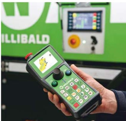
Über eine neue Steuerung mit übersichtlichem Display und passendem Funk (Handsender) lässt sich der Schredder optimal bedienen. Alle wichtigen Maschinenparameter können schnell abgerufen werden
