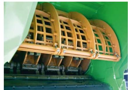
Die größeren dreiteiligen Siebkörbe sorgen für eine gute Nachzerkleinerung und verbessern somit die Qualität des Endmaterials entscheidend
