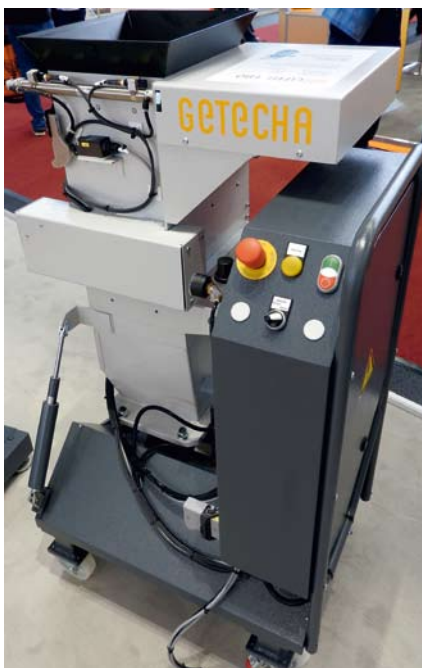
Die Sauberraum-Mühle GRS 180 zeichnet sich unter anderem durch ihre platzsparende Niedrigbauweise aus
