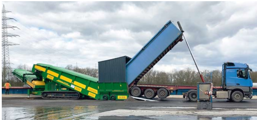
Aufnahme und Verladung des Schüttguts erfolgen ohne zeitaufwendigen Zwischenschritt
