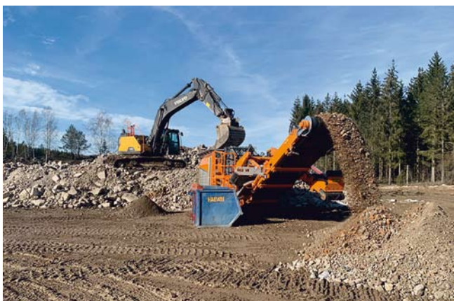
In Norrköping, Schweden, bricht der Rockster R1000S schwer armierten Bauschutt auf 0-80 mm
