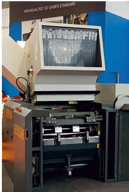
Die Zentralmühle 45090 ist ausgelegt für Durchsätze von bis zu 900 kg/h
