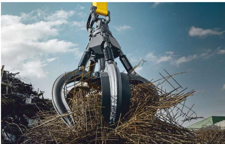
Der neue GMM 50-5 ist prädestiniert für härteste Einsätze im Bereich der Recycling- und Schrottverwertung. Für unterschiedliche Materialien stehen drei perfekt konzipierte Schalenformen zur Auswahl
