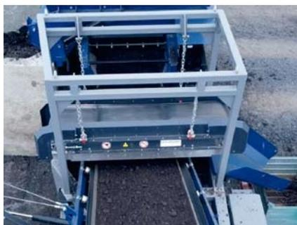
In Magnetabscheidern sind Ferrit- oder Neodym-Magneten eingebaut, wobei letztere von einem 2-poligen zu einem 3-poligen System aufgerüstet werden. Dieses modifizierte Design bietet ein stärkeres Magnetfeld bei gleicher Anzahl von Magneten. Das kompakte und starke 3-polige Neodym-Überband ermöglicht eine größere Rotation des
