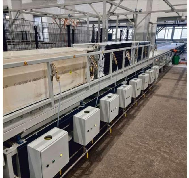
Die Kältemittel-Absauganlage ist TÜV-zertifiziert, TA Luft-konform und entspricht allen relevanten Vorschriften wie dem AwSV-Gutachten sowie der ATEX-Richtlinie
