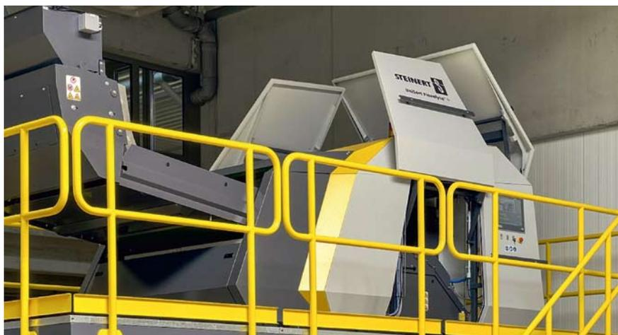
Automatischer Weißabgleich zur Kalibrierung und Splitfunktionalität für gleichzeitige Sortiervorgänge auf einer Maschine
