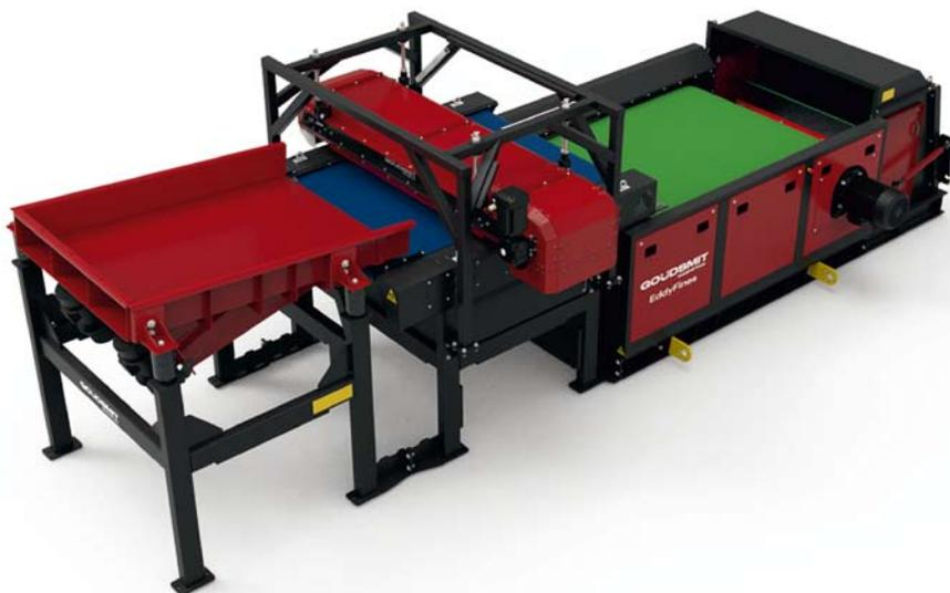
Der dreistufige Metallabscheider besteht aus einer Kombination von Hochgradienten-, Überband- und Wirbelstromabscheider
