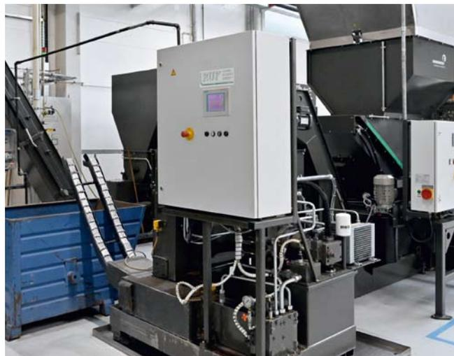
Zwei der elf Brikettpressen hat Multivac an zentraler Stelle installiert. Dort können Späne aus verschiedenen Bearbeitungszentren brikettiert werden
