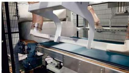
Blick in die Kanisterverpackungsanlage von Getecha: Die Kanister werden lagenweise eingeschweißt und überstehende Folie abgeschnitten; anschließend erfolgt das Schrumpfen der Folie mit bis zu 200 °C
