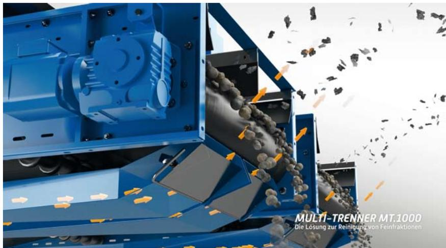
Leichtfraktionen werden mittels Luftstrom getrennt
