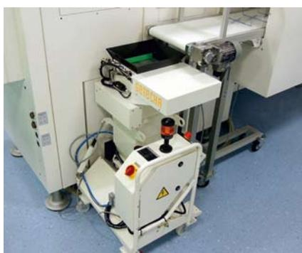
Die fertigungsintegrierte Zerkleinerung kleiner Pipetten, Ausschussflaschen und Butzen ist die Domäne der Beistellmühlen GRS 180/300 von Getecha. Das Bild zeigt eine Sauberraum-Ausführung mit Schleusenzuführung
