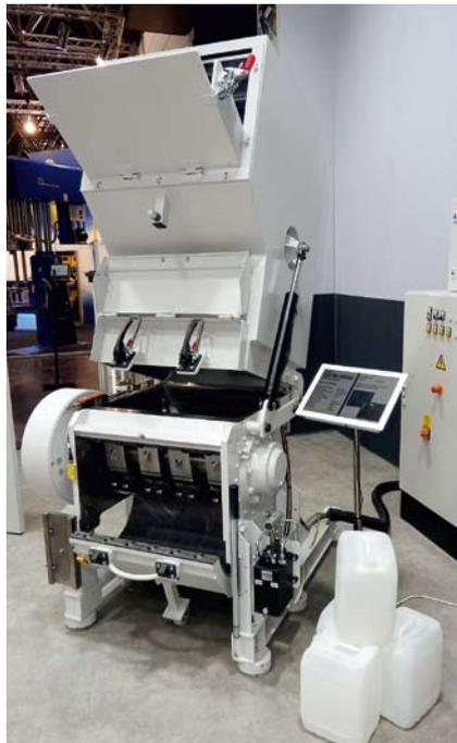
Während eine Getecha RS 2404-B einen Stundendurchsatz von bis zu 160 kg erzielt, zerkleinert eine RS 38060-B (Bild) bis zu 600 kg Material stündlich
