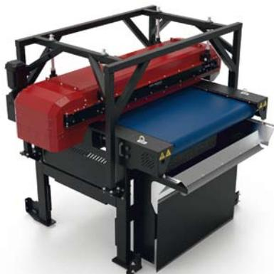
Das Hochgradientenmodul ist auch nur mit einem Überbandmagneten für die Abscheidung von Stahl-, Feineisen- und Edelstahlpartikeln erhältlich
