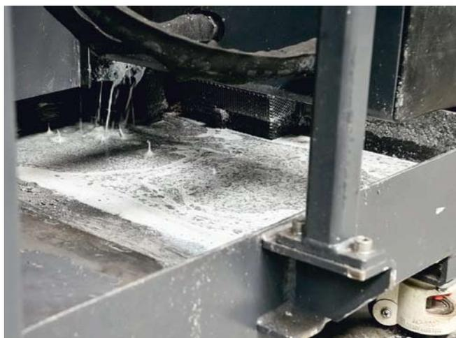
In einer Wanne sammeln die Brikettieranlagen das aus den Aluspänen herausgepresste Kühlschmiermittel. Von dort wird es über einen Filter direkt zurück in die Bearbeitungszentren gepumpt
