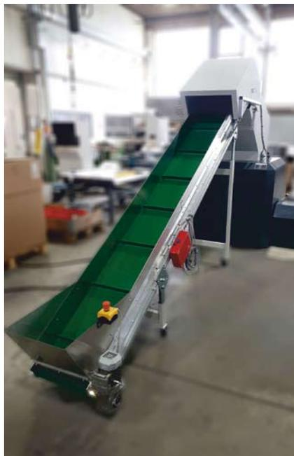
Getecha-Zerkleinerungsmühle mit Steigförderband zur kontinuierlichen, automatischen Zerkleinerung blasgeformter Behälter und Butzen kurz vor der Auslieferung
