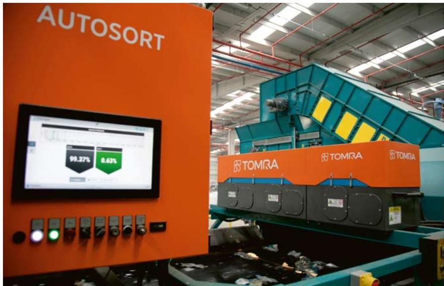
Die Sortiersysteme der Anlage umfassen vier Autosort-, zwei Innosort Flake- und zwei Autosort Flake-Einheiten
