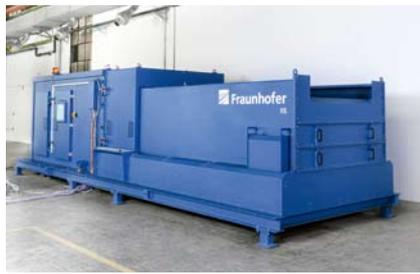
Am Fraunhofer IIS werden Abfallströme von einem Prototyp-Sortiersystem mithilfe von künstlicher Intelligenz und Röntgentechnologie durchleuchtet, um kritische Batterien rechtzeitig zu separieren
