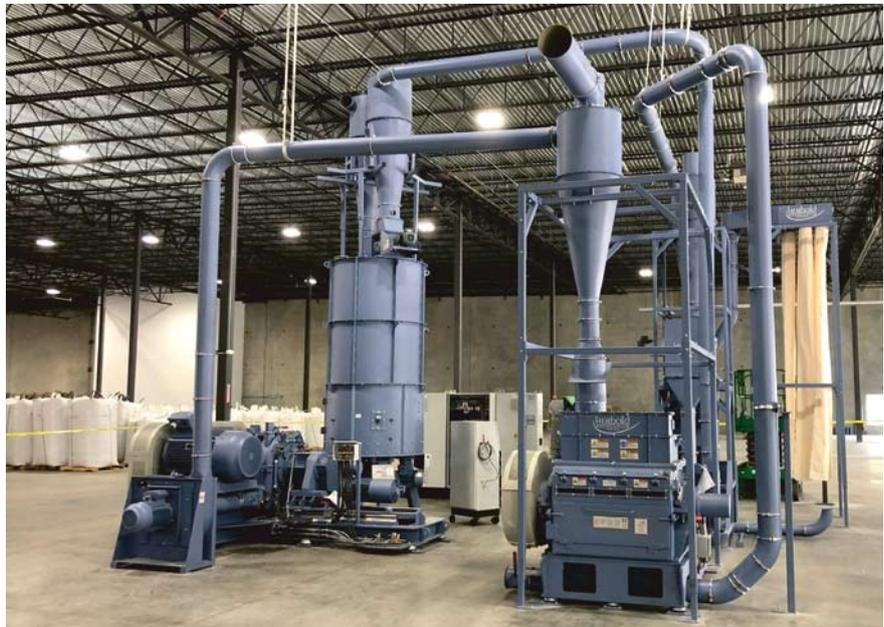
Zuführschnecke diverse Zuschlagstoffe wie Gleitmittel, Weichmacher oder Farbpigmente intensiv eingearbeitet werden. Compoundierung oder die Kristallisierung von PET-Flakes sind weitere Anwendungsfelder. Der HV 70 von Herbold Meckesheim verbindet zudem eine hohe Durchsatzleistung mit geringen Wartungskosten und einer vollautomatischen Steuerung, in der sich Einstellungen für unterschiedliche Aufgabematerialien hinterlegen lassen. Und die dank Leistungs- und
