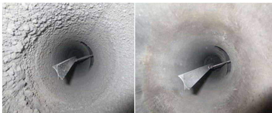
Blick in den Oeko-Tube-Inside: Abgeschiedener Feinstaub nach circa 100 Betriebsstunden mit Holzhackgut (links) und nach erfolgter Abreinigung der Staubschicht (rechts)
