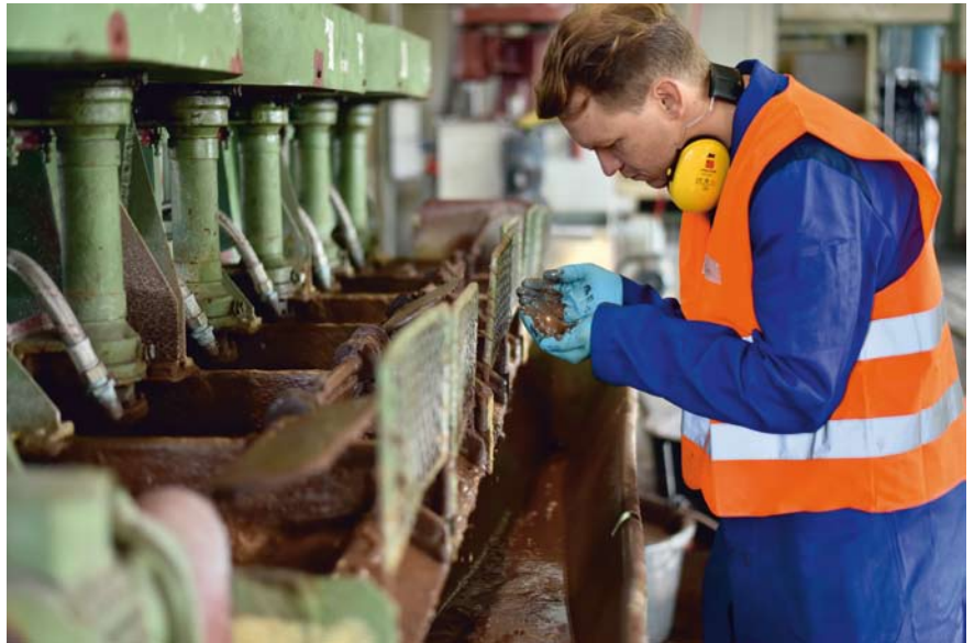
Erzaubereitung mit Schaumflotation: Dr. Martin Rudolph (Helmholtz-Institut Freiberg für Ressourcentechnologie des HZDR) an der Pilotanlage in Freiberg
