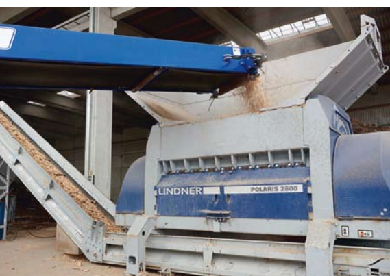
Der Lindner Zerkleinerer Polaris 2800 ist für den Dauerbetrieb ausgerichtet
