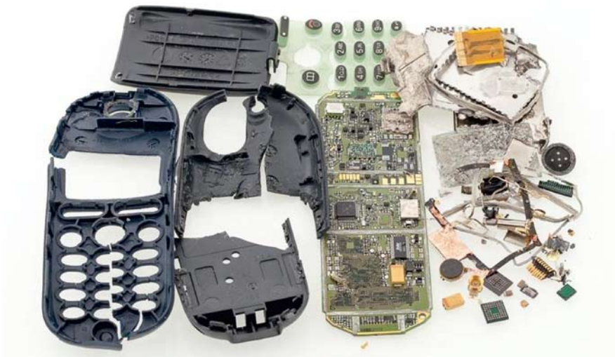
Mobiltelefon nach Anwendung des Schockwellenverfahrens
