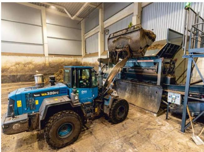
Mit dem langsam laufenden Zerkleinerer Crambo kann der Bioabfall besonders schonend aufgeschlossen werden
