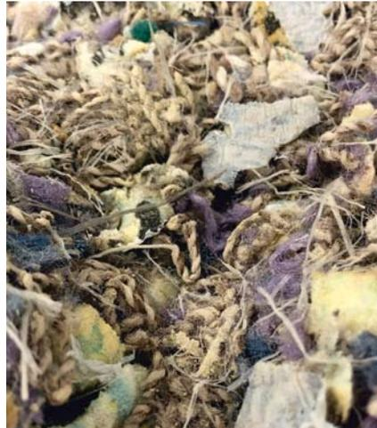
Zerkleinerte Teppichabfälle, die anschließend gereinigt und mit ionischem Liquid versetzt werden
