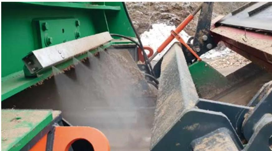
Durch die Benebelung des Materials während des Schreddervorgangs wird die Staubentwicklung weitestgehend vermieden. Durch die robuste, patentierte Einhausung sind die Düsen auch bei der Schüttgutverarbeitung vor Steinschlägen und somit vor Beschädigungen geschützt
