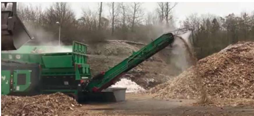
Diese Schredderanlage wurde mit einer Staubbindeanlage von NEBOLEX Umwelttechnik ausgerüstet. Hier wird das Material beim Abwurf befeuchtet. Die Staubminderung ist enorm und beträgt circa 90 Prozent
