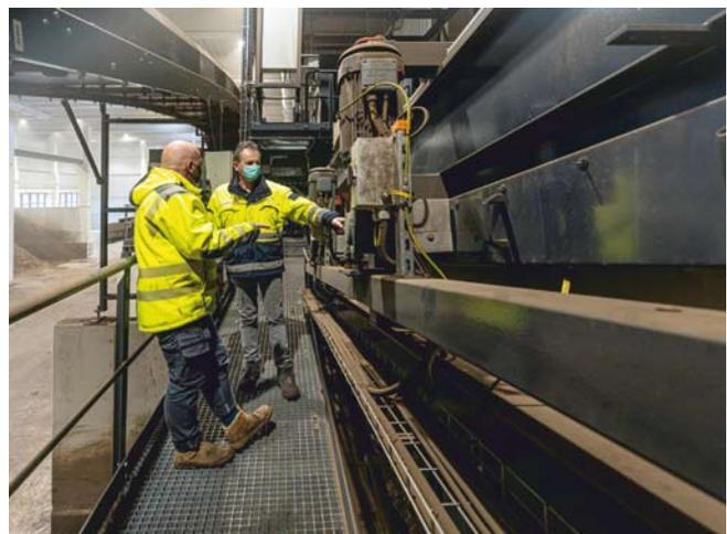
Beim Sternsieb verfügen Elektromotoren mit Frequenzumrichtern über exakte Einstellmöglichkeiten
