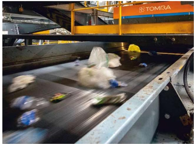
Die Autosort-Maschinen von Tomra kombinieren NIR- (Nahinfrarotwellenlängen) und VIS-Sensoren (sichtbare Wellenlängen) in einem modularen Sortiersystem, das es Anlagenbetreiber ermöglicht, große Materialmengen präzise zu erkennen und mit maximaler Geschwindigkeit nach Art und Zusammensetzung zu trennen, was zu hochreinen Endfraktionen führt. In der Masotina-Anlage ermöglicht die NIR-Technologie die Auswahl nach Polymertyp und die VIS-Technologie die Auswahl nach Farbe (im Fall von PET).
