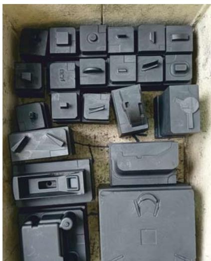
Zusammenstellung gebrauchter Graphitelektroden für die Zerkleinerung
