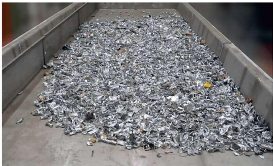
Aluminiumschrott mit hoher Feuchte vor Lufttrocknung mit bis zu 140 °C
