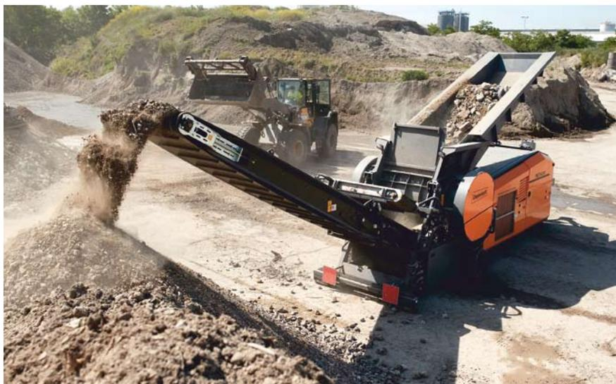
Die Maschine eignet sich für Einsätze bei permanent wechselndem Material wie Gewerbeabfall, Baumischabfall, Matratzen, Bioabfall oder Altholz
