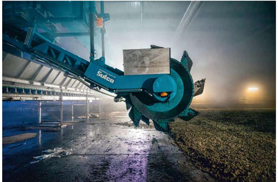
nation mehrerer Behandlungslinien erreicht der Wendelin eine maximale Durchsatzleistung von 400.000 Tonnen pro Jahr, erwartet Sutco. Als weiterer Vorteil des Baukastensystems erweist sich der große Gestaltungsspielraum, der sich für Anlagenbetreiber ergibt. Insbesondere bei eingeschränkten Platzverhältnissen werden hierdurch praktikable Lösungen möglich.
