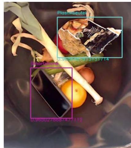
Viel zu häufig landen im Biomüll Störstoffe, die den Recyclingprozess aufwändig und teuer oder sogar unmöglich machen. Dem neuen System zur Störstofferkennung c-detect entgeht nichts, und es bietet eine sichere Nachweisführung von Verunreinigungen und deren Verursachern
