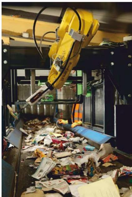
dass die Trennung von Kunststoffen und anderen wertvollen Abfällen von gemischten Abfällen mit geringem Wert weitgehend manuell erfolgt und unerschwingliche Kosten mit sich bringt. Durch die Automatisierung des Prozesses mithilfe von KI wollen Dewulf und Hedley den Anteil des recycelten Abfalls erhöhen.
