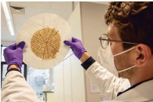
Hat sich der Karton aus den Gipskartonplatten ausreichend im Wasser aufgelöst? Das prüft Wojciech Walica mit Blick auf das Filterpapier – ein Testschritt auf dem Weg zur Herstellung von Gipsfaserplatten aus Recyclingmaterial
