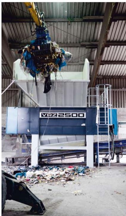
Der Zerkleinerer VRZ ist robust, störstoffresistent, zuverlässig und wartungsarm und somit bestens geeignet für die Aufbereitung von Haus- und Gewerbeabfällen
