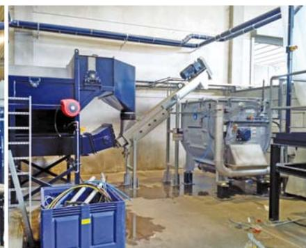
Trenntank, Entwässerungsschnecke und mechanischer Trockner
